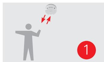
1. Nehmen Sie den Rauchwarnmelder für mindestens 1 Min. von der Grundplatte ab und montieren ihn anschließend wieder auf die Grundplatte.
