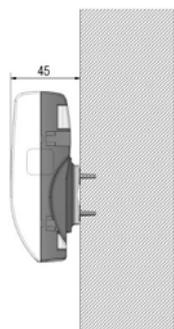
Par défaut, l'unité arithmétique est montée directement sur le débitmètre. Lors d'une température du fluide supérieure à 30°C, nous recommandons son montage au mur. Il faut également la fixer séparément à un mur plat, si les conditions d'installation sont étroites et limitent la lisibilité. – Pour effectuer le montage au mur, il existe une plaque spécifique à cet effet.
