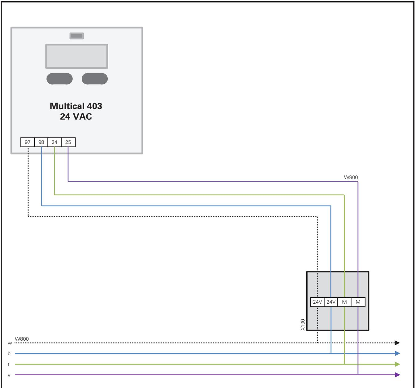
X100 AP Boîte de jonction montage apparent plombable (par ex. Woertz 78x78mm)
