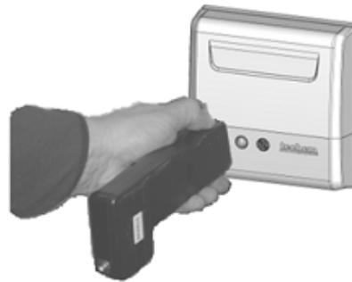
Parametrierung (kodieren) mit Optokopf OK II
