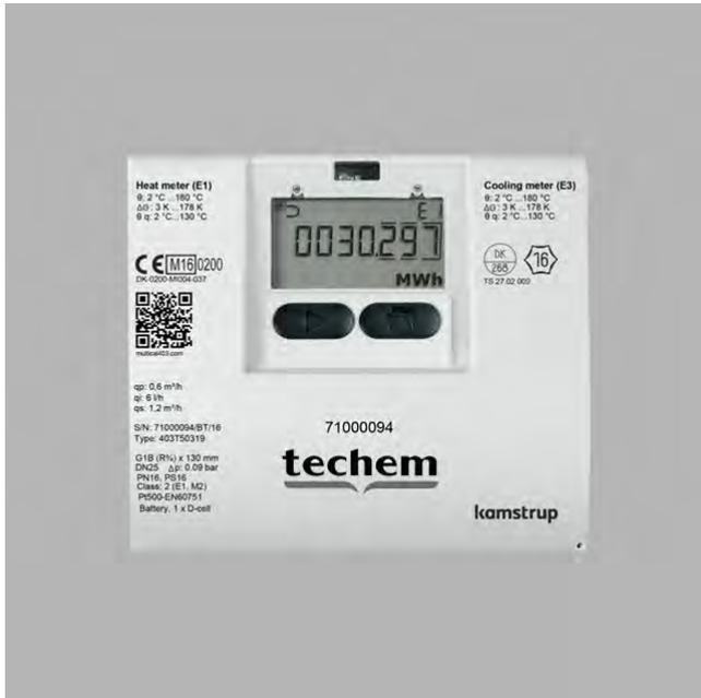
Der Kältezähler Multical 403 hat **zwei Bedientöpfe**, deren Funktion auf der Seite 6.9.20 beschrieben ist.
