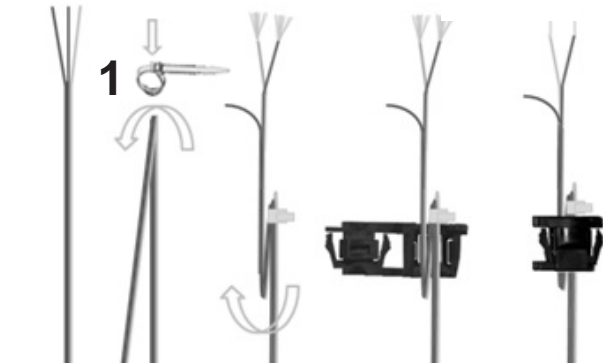
Vorgehensweise bei dünnem Pulsgeberkabel
