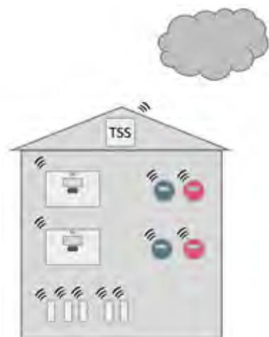
En plus des compteurs radio, des collecteurs de données sont installés dans la cage d'escalier.
