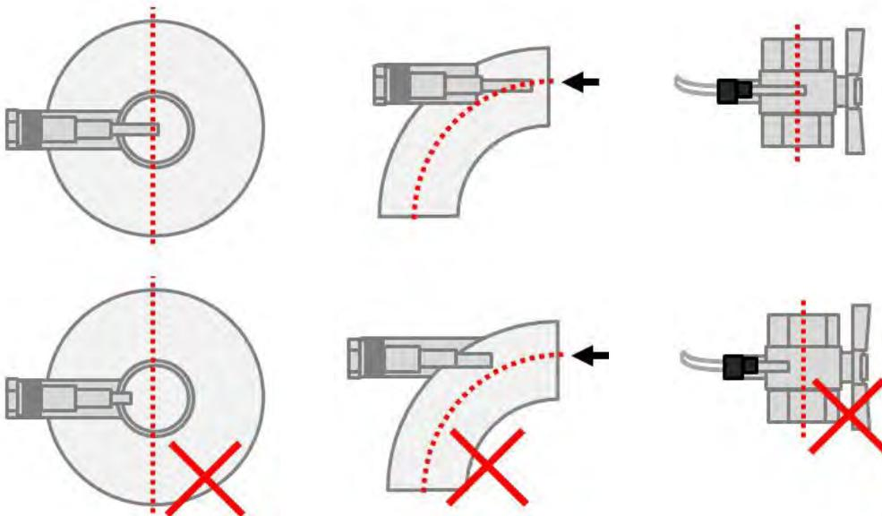
Wird der Fühler direkttauchend in einen Kugelhahn verbaut, ist diese Vorgabe bis und mit einem Kugelhahn der Nennweite DN25 gewährleistet. Bei Kombinationen eines T-Stücks mit einem Fühleradapter wird die minimale Eintauchtiefe häufig nicht erreicht.
