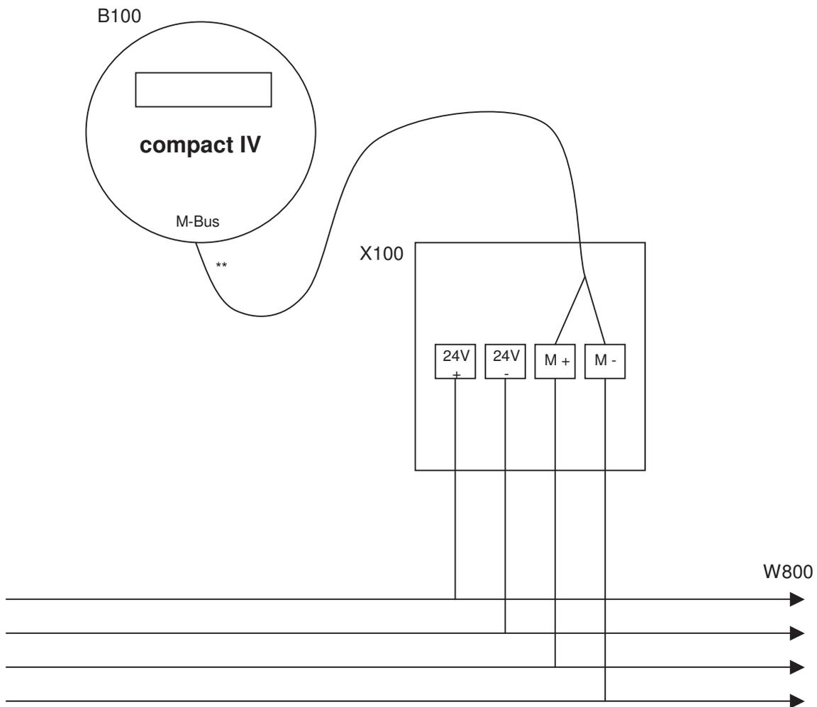
B100 Wärmehzähler compact IV M-Bus
