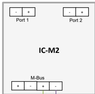
An einen IC-M2 können zwei Impulszähler mit potentialfreien Ausgängen angeschlossen werden.
