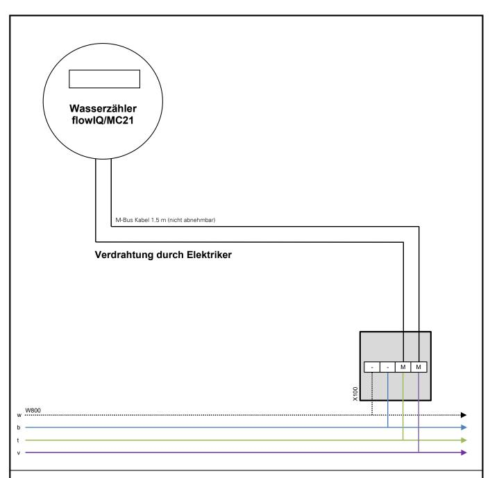
Für die Verbindung bei Unterputzzählern sind zwingend Einzeladerverbinder Scotchlok zu verwenden (nicht lösbar).
