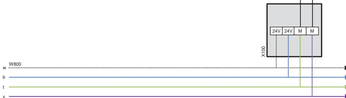
Für die Verbindung bei Unterputzzählern sind zwingend Einzeladerverbinder Scotchlok zu verwenden (nicht lösbar).
