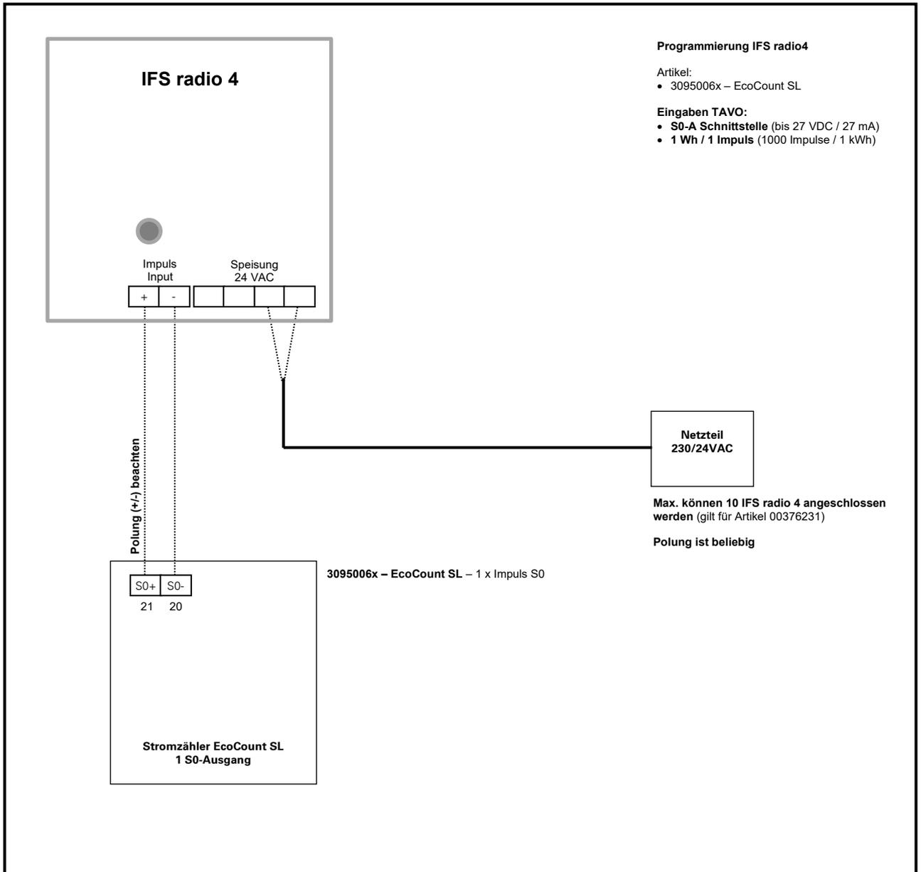
**Anschluss Zähler mit S0-Ausgang (elektrisch passiv)**
