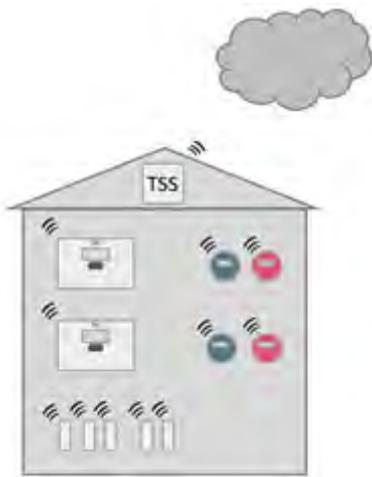
Zusätzlich zu den Funkzählern werden im Treppenhaus Datensammler installiert. Diese empfangen die verschlüsselten Zählerstände und geben sie über das Mobilfunknetz an das Techem Rechenzentrum weiter.
